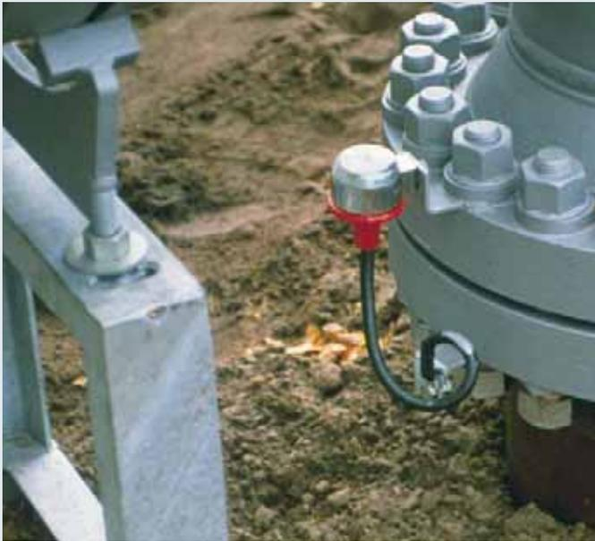
Разделительный искровой разрядник с низким напряжением срабатывания, имеет сертификат ATEX для молниезащитного уравнивания потенциалов согласно DIN EN 62305 / VDE 0185, с гибким соединительным проводником
