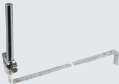
Используется в качестве основания для монтажа молниеприемника на двухскатных кровлях с зубчатой шайбой для защиты от раскручивания и контргайкой. Требуется дополнительное крепление молниеприемника, например, к дымовой трубе с помощью дистанционного держателя DEHNiso.
