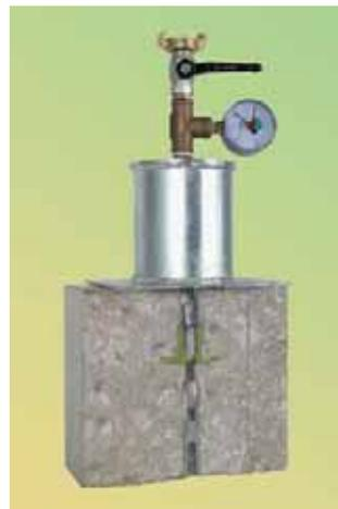
Рис. 2: Конструкция для испытания вводов под давлением
