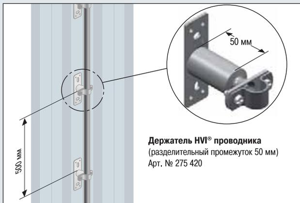
Схема – прокладка в Ех-зоне 1 или 2 и 21 или 22 на металлическом фасаде.
