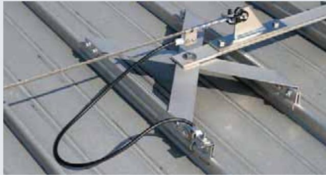
Комплект для крепления на кровлях тросов, использующихся в качестве молниеприемников. В комплекте с платой для подключения троса (Ø 8 мм) и клеммным зажимом (6-10 мм).
