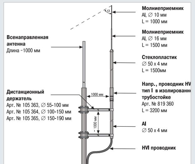
Рис. 2: Пример конструкции для защиты всенаправленной антенны высотой 3000 мм
