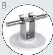
Для установки молниеприёмных систем, например, на кровлях, покрытых трапецидальными листами. Держатель проводника может использоваться на гладких (без фактуры) поверхностях, таких как металлические кровли и металлические поверхности. Держатели проводника приклеиваются к кровле после удаления защитной пленки.
