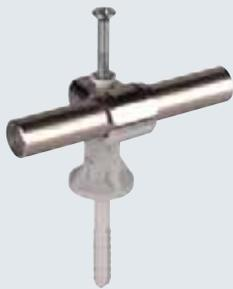
Крепежные элементы с двумя функциями (крепление держателя и крепление проводника), жесткое крепление проводника, высота 42 мм, глубина крепежного отверстия 60 мм, Ø крепежного отверстия 8 мм
