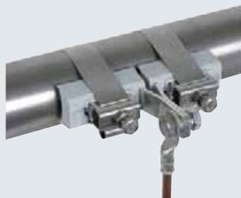
Ленточный хомут для включения труб во взрывоопасных зонах в систему молниезащитного уравнивания потенциалов согласно DIN EN 62305-3.
